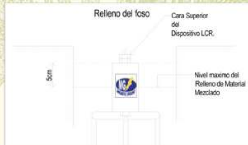
Figura 2. Relleno del foso
